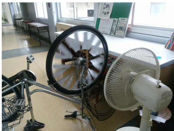
図1 自転車を利用した発電装置
